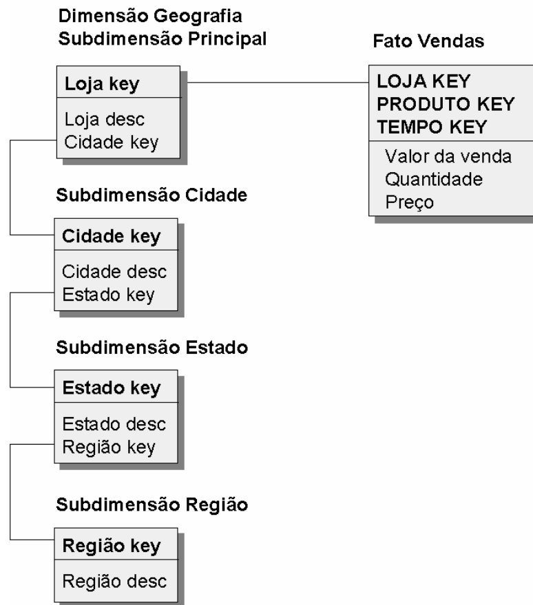
Figura 18 – Exemplo de implementação do esquema Snowflake Chain, representando a ligação da tabela Fato com a dimensão Geografia (dividida em subdimensões encadeadas).
