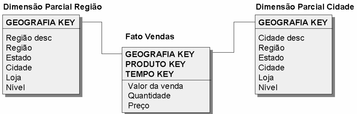
Figura 15 – Implementação do esquema Dimension Partitioning , representando o particionamento da tabela dimensão Geografia.
